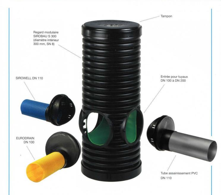
Ce regard ou chambre de visite modulaire SIROBAU S 300 à 3 réservations permet un raccordement simple et efficace de tous les drains annelés SIROWELL et EURODRAIN ou des tuyaux lisses en PVC.
